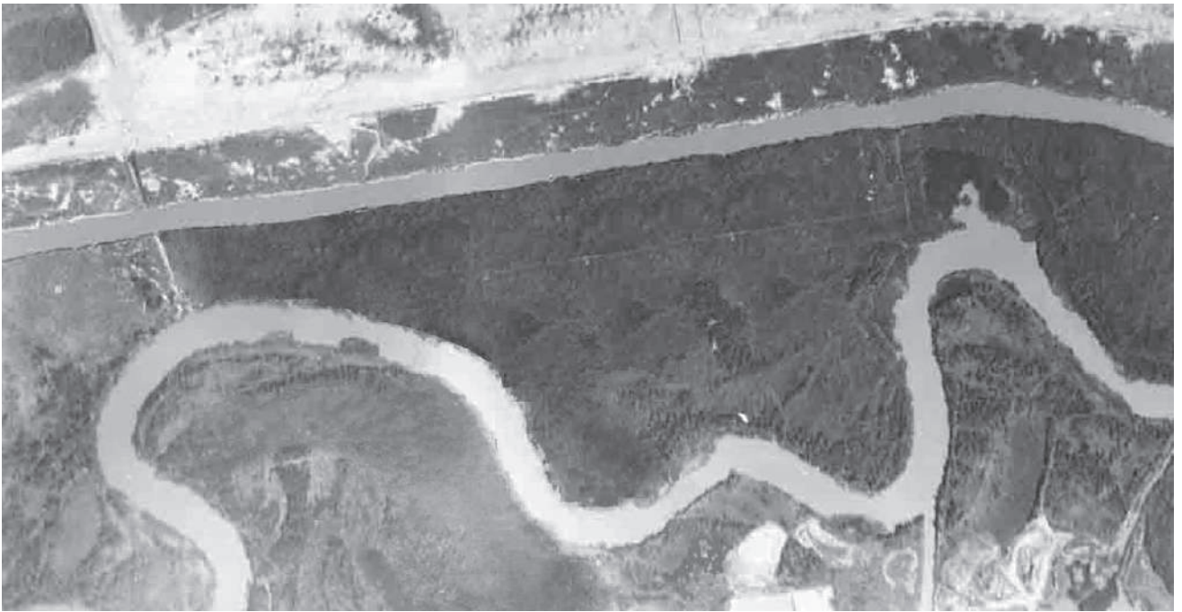
fig. 59 - retificação do canal do rio Pinheiros -1937 Fonte: Arquivo Eletropaulo
