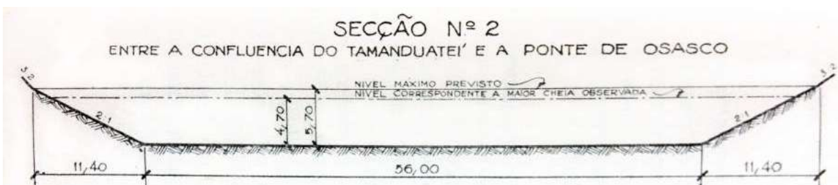
fig. 54 - Seção transversal Tietê, entre Tamanduateí e Osasco- Solução CMRT III Fonte: (SILVA, L. 1950)
